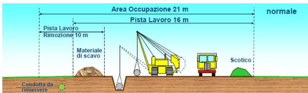
Figura 0-4 Pista di lavoro DN 250/300 - Metanodotto in parallelismo con esistente da dismettere
