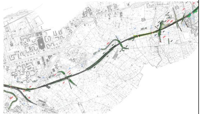
Planimetria di inquadramento delle opere indicate come passaggi faunistici con le relative distanze.
