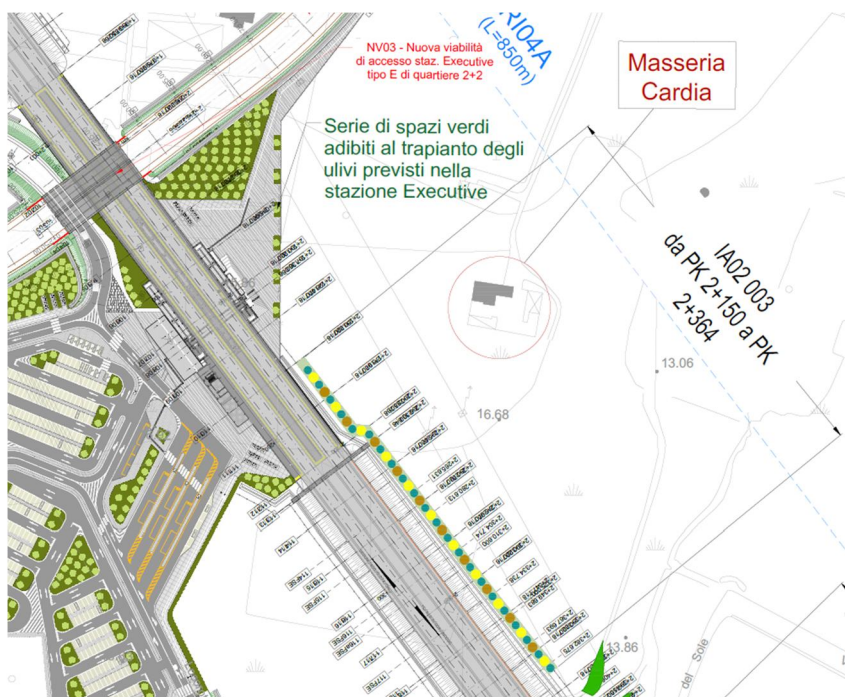
Planimetria con indicazione delle opere a verde previste nel progetto esecutivo a schermare la visuale su Masseria Cardia
