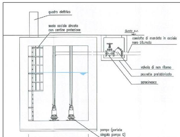
La funzione dell'impianto è quella di impedire l'innalzamento del livello d'acqua nella vasca interrata oltre un livello massimo stabilito. Il progetto è stato sviluppato per fronteggiare eventuali carichi variabili prevedendo gruppi di sollevamento multi-pompa, con una unità in riserva.
