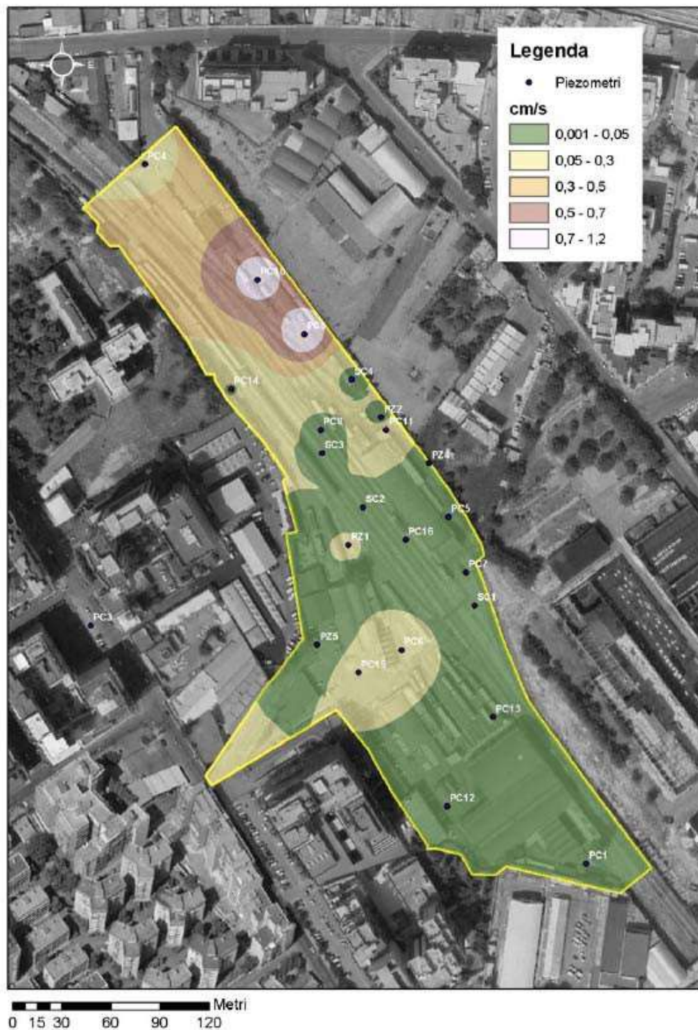
Figura 5.1 - Distribuzione dei valori del coefficiente di permeabilità dell'acquifero carbonatico profondo ottenuto con formule analitiche chiuse e interpolazione geostatistica
