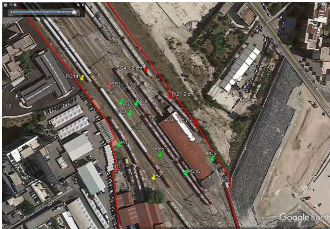
Figura 5.8: Planimetria con l'ubicazione dei piezometri monitorati il 30/04/2019. Legenda: rosso=presenza di surnatante; giallo=piezometri non accessibili; verde=assenza di surnatante.
