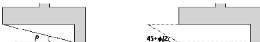
**Figura 6-1: Calcolo del cuneo di scivolamento passivo nel caso di dente di fondazione**
