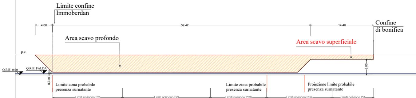
Le quote di fondo scavo dell'area di scavo profondo verranno stabilite a seguito di opportuna verifica del livello piezometrico
