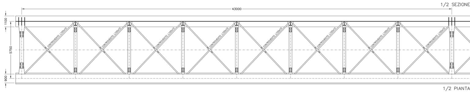
SEZIONE LONGITUDINALE CAMPATA 1 CARREGGIATA SX tipo L=43m SCALA 1:100
