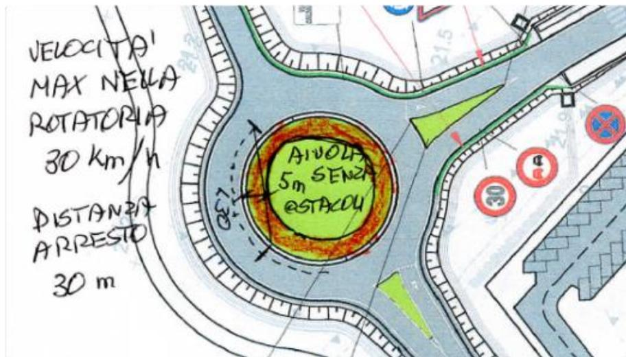
Come si nota dalla planimetria per una visione completa al disopra dell'isola centrale dello spazio distante dal conducente in curva di circa 30m è necessario che vi sia una corona di 3.50m libera dalla presenza di piante o di altre attrezzature (ringhiere, tabelloni pubblicitari, ecc.); la segnaletica od i pali di illuminazione non sono considerati ostacoli per la visibilità.
