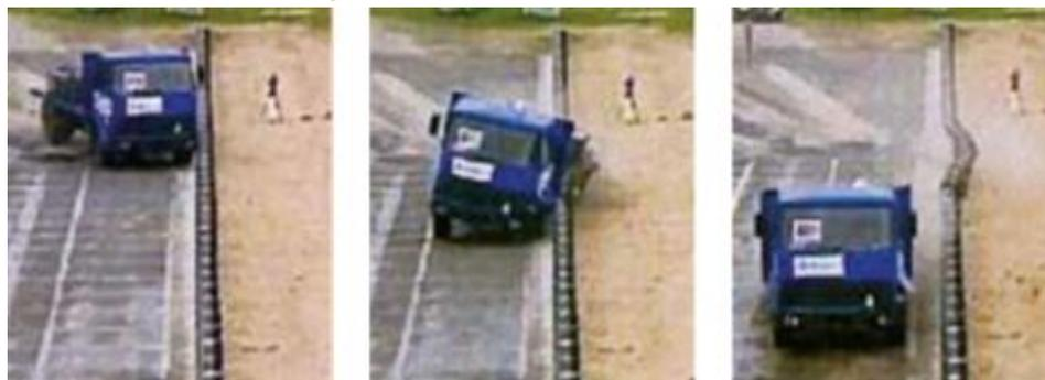
Le istruzioni pre-normative stabiliscono (art.7- Criteri di progettazione- C.1 Margine esterno) che *“la larghezza del tratto sub-orizzontale dell'arginello, necessario per garantire la stabilità del veicolo in svio, deve essere almeno pari alla deflessione dinamica massima della barriera, ridotta di 70 cm per le prove con veicoli pesanti e di 20 cm per le prove con i veicoli leggeri”*.
