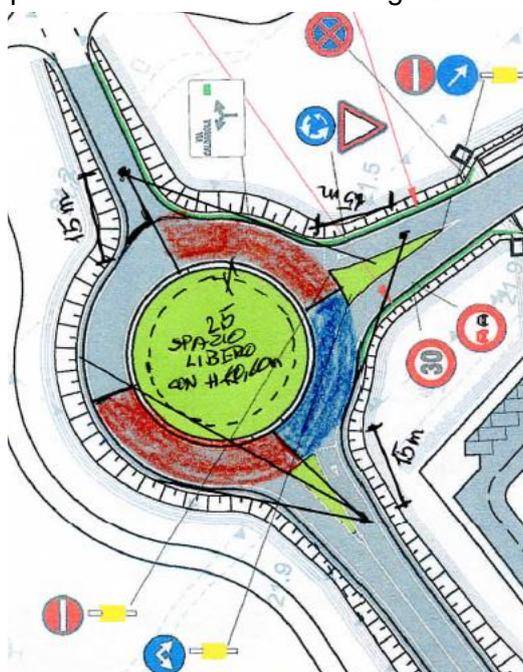
Le distanze di visibilità sono assicurate per i tre rami di ingresso. Le barriere di ritenuta poste sull'arginello dell'anello esterno della rotatoria non riducono la visibilità; la barriera H2 bordo laterale è alta 95cm ed è inferiore alla altezza degli occhi del conducente, prevista dalle norme ad 1.10m sul piano stradale. Sulle isole triangolari non sono previste barriere e gli eventuali arbusti non possono essere di altezza maggiore di 60cm.
