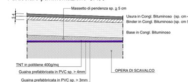
ma a trama e ordito, costituito da fibre in poliestere o polipropilene, della massa da 401 a 500 : longitudinale (ordito) e trasversale (trama) = 80 kn/m, relativo allungamento a rottura per : 25% resistenza al punzonamento non inferiore a 10.000 N
