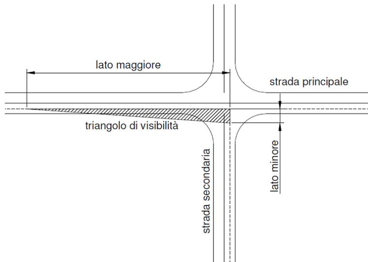
Nel caso di regolazione con STOP, un veicolo collocato a una distanza di 3 m dalla linea di arresto deve poter avvistare un veicolo che percorre la strada principale, quando quest'ultimo si trova a una distanza  $D$ , definita:  $D = t \cdot v$  ove
