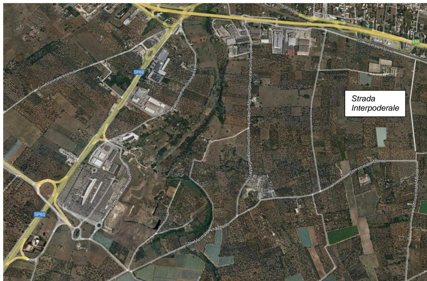
L'attuale strada locale è larga all'incirca fra 2.10 e 2.60 m, è pavimentata in terra e ghiaia e non presenta fossi di guardia laterali. Date la larghezza e l'irregolarità della pavimentazione stradale, la massima velocità di percorrenza possibile per i veicoli transitanti è inferiore a 30 km/h. La circolazione lungo la strada interpodereale è attualmente a senso unico alternato.
