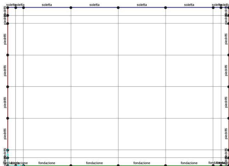
Figura 8 – Sezioni del calcestruzzo del tombino
