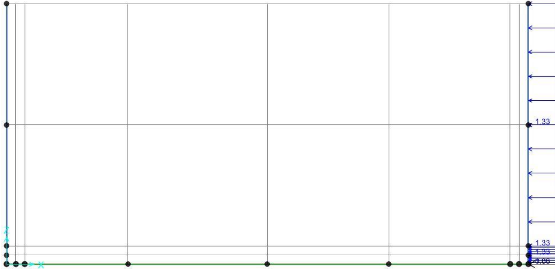
Figura 173 – Sovrappinta delle terre in SLV, uniforme
