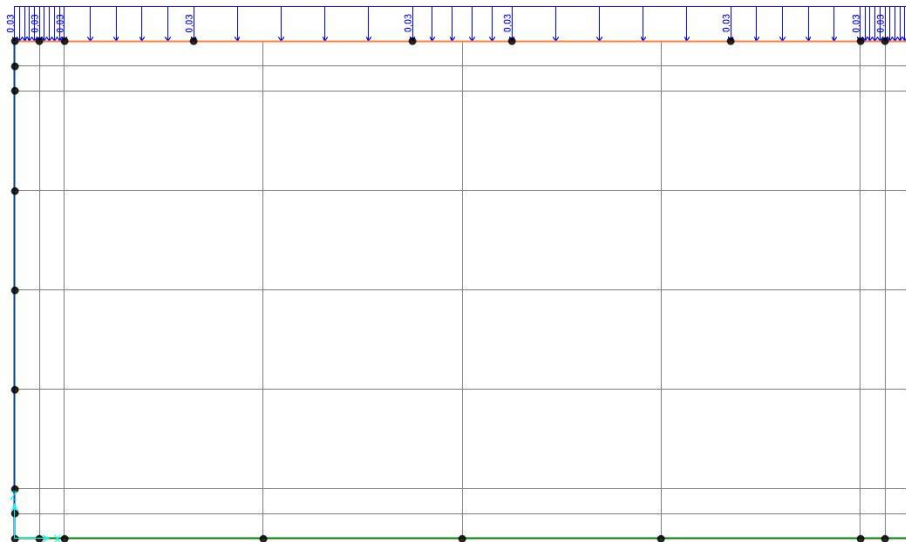
Figura 127 – Azione sismica SLV- G2, direzione verticale
