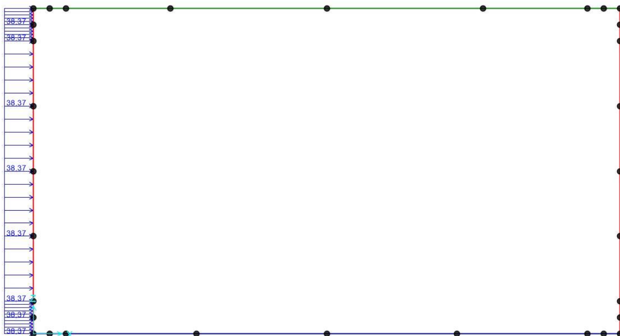
Figura 18 – Spinta a riposo da sovraccarichi di traffico ferroviario
