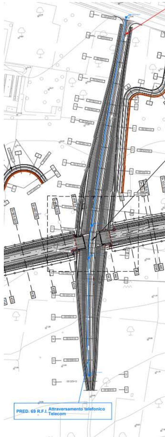
Figura 22: Predisposizione della linea telefonica 69
