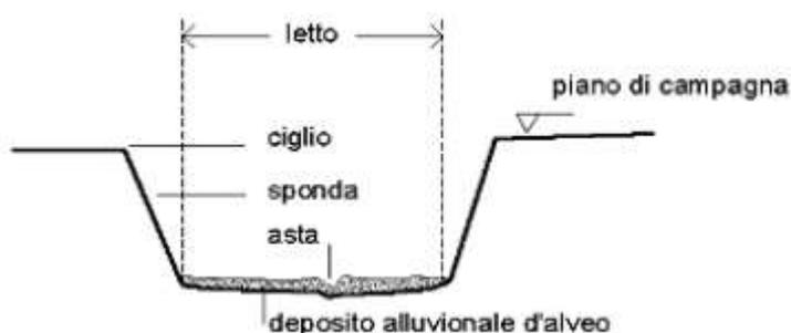
**Figura 4 – Sezione trasversale del solco carsico di lama San Giorgio (“Studio di fattibilità per l’integrazione degli studi propedeutici per la predisposizione del piano stralcio della dinamica delle coste”).**
