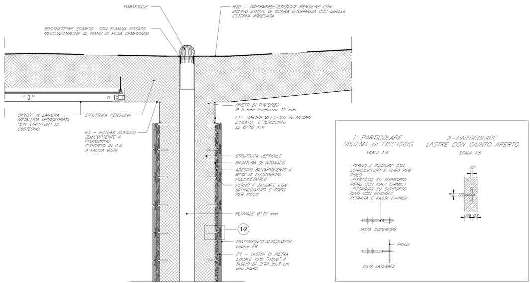
1-PARTICOLARE SISTEMA DI FISSAGGIO
