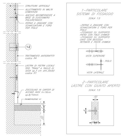
1-PARTICOLARE SISTEMA DI FISSAGGIO
