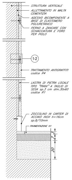
1-PARTICOLARE SISTEMA DI FISSAGGIO
