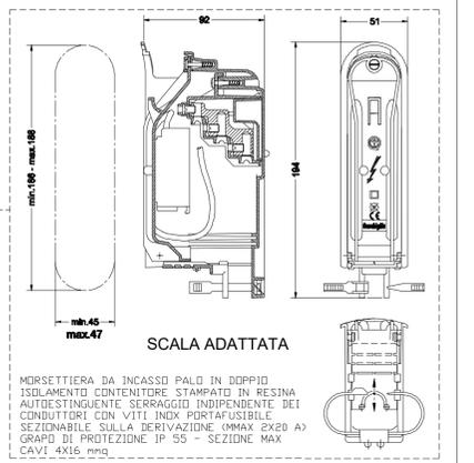
SEZIONE TRASVERSALE - in asse appoggio -
