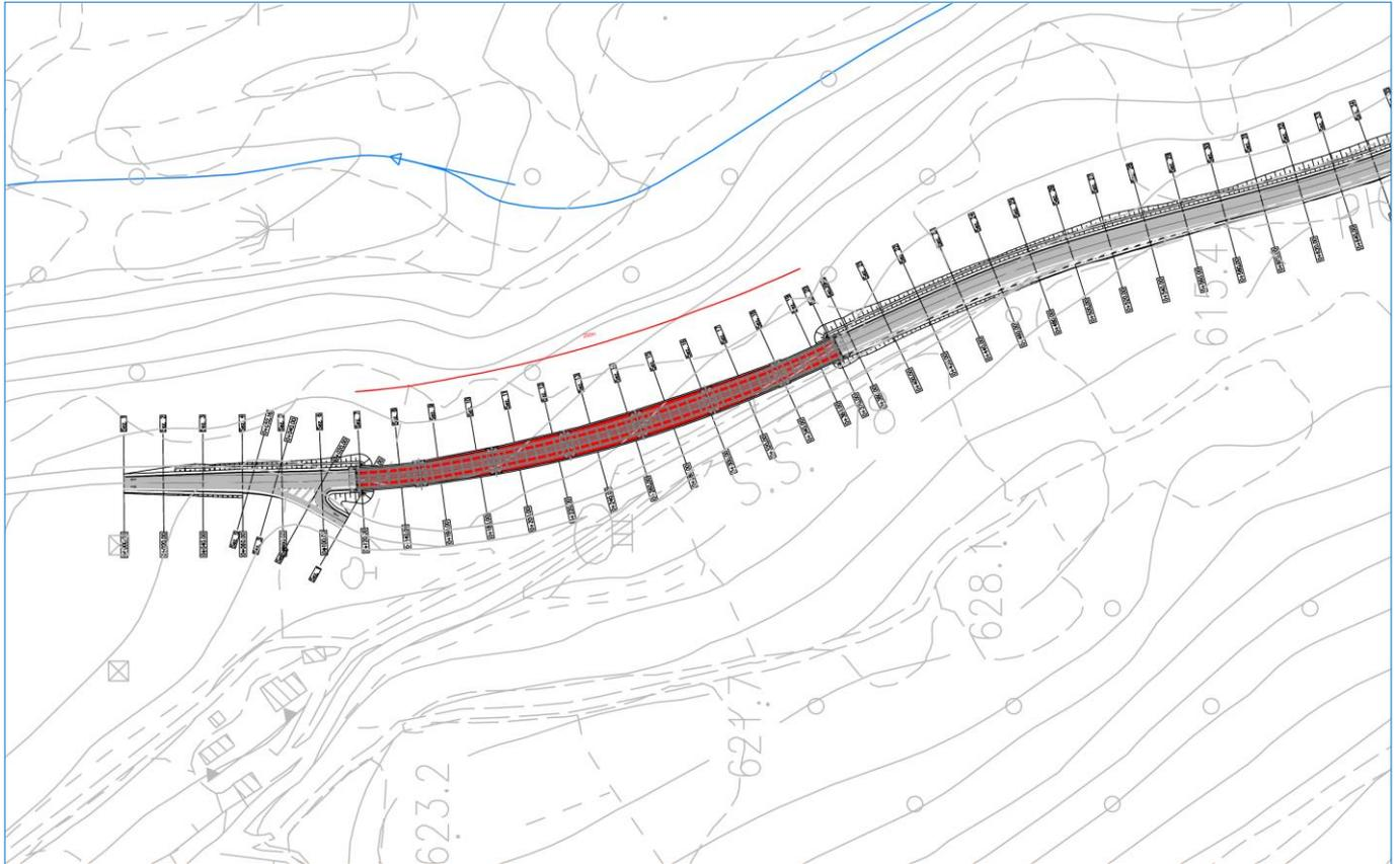
Il nuovo tracciamento ha previsto la realizzazione di un viadotto a n.7 campate di estensione complessiva pari a 250m (estensione misurata in asse appoggi spalla).
