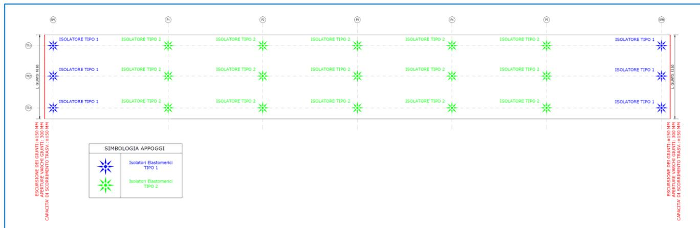
La pila è prevista realizzata con fusto a pianta rettangolare (sezione resistente) rifinito alle estremità con smussature circolari. La larghezza è pari a 150cm. Gli appoggi sono previsti alloggiati su appositi boggini, mentre lateralmente sono previsti appositi elementi di ritegno che hanno anche la funzione di mascherare alla vista gli apparecchi di appoggio.
