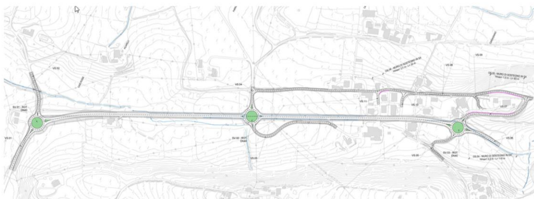
Figura 3-14 - Intervento tratto Cardagnano Alto con adeguamento viabilità principale e accessoria
