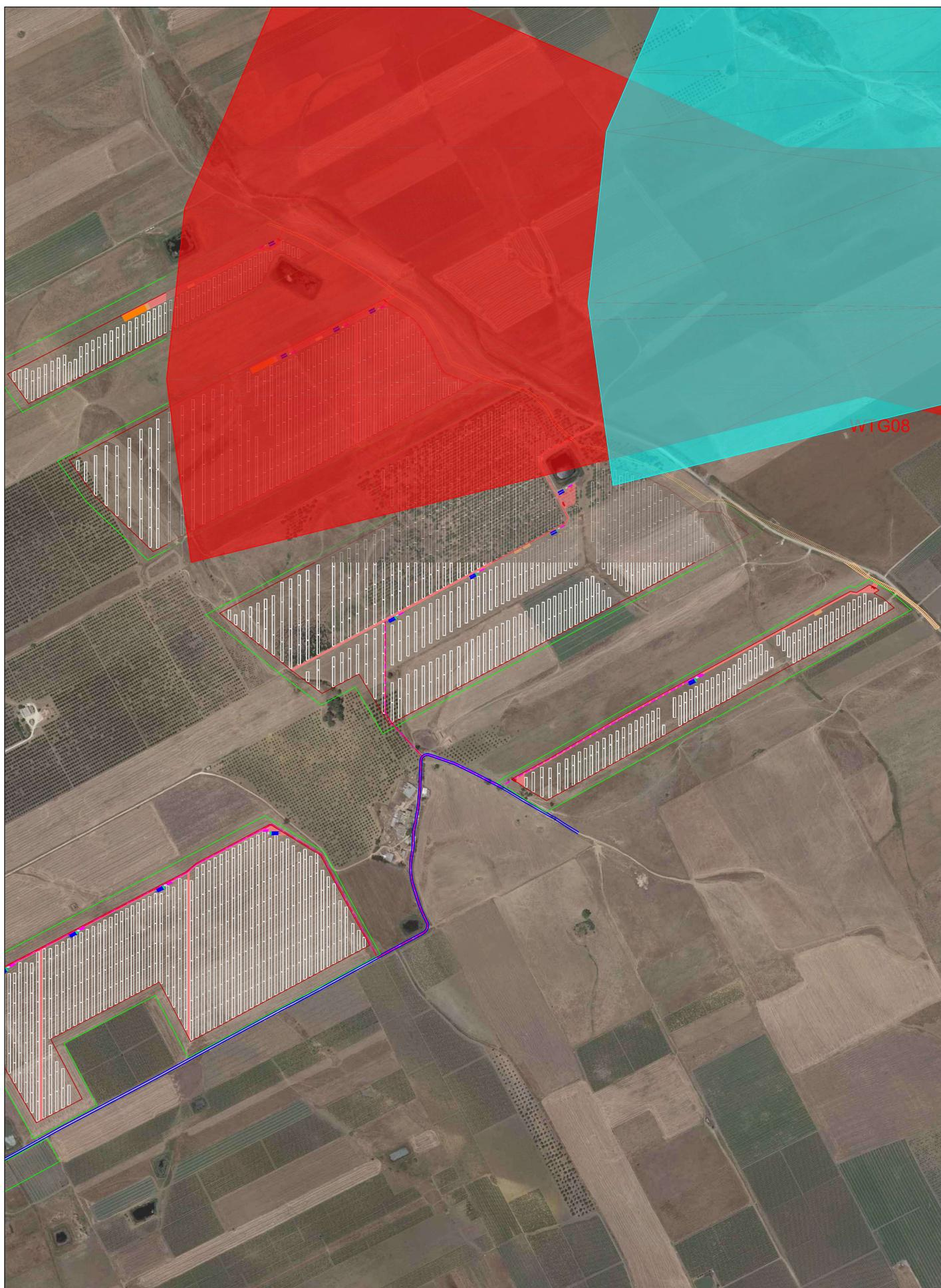
Planimetria con indicazione dell'ombreggiamento prodotto dagli aerogeneratori WTG08 e WTG07 (AEI WIND PROJECT II S.R.L. ) sul generatore fotovoltaico (PCC-PV01-02, Paceco Solar srl)
