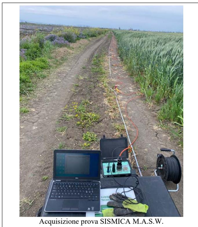
Acquisizione prova SISMICA M.A.S.W.
