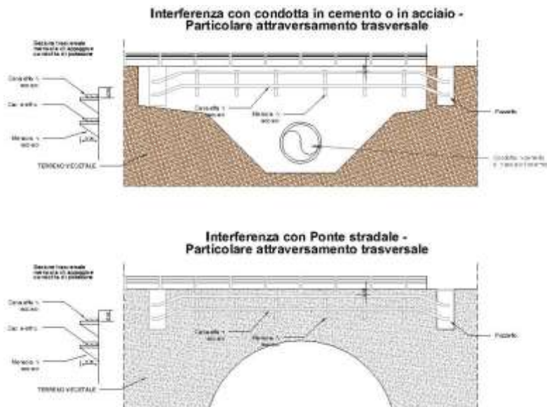
Figura 23: Particolare attraversamento trasversale in prossimità di interferenza con condotta in cemento o in acciaio e di interferenza con ponte stradale.
