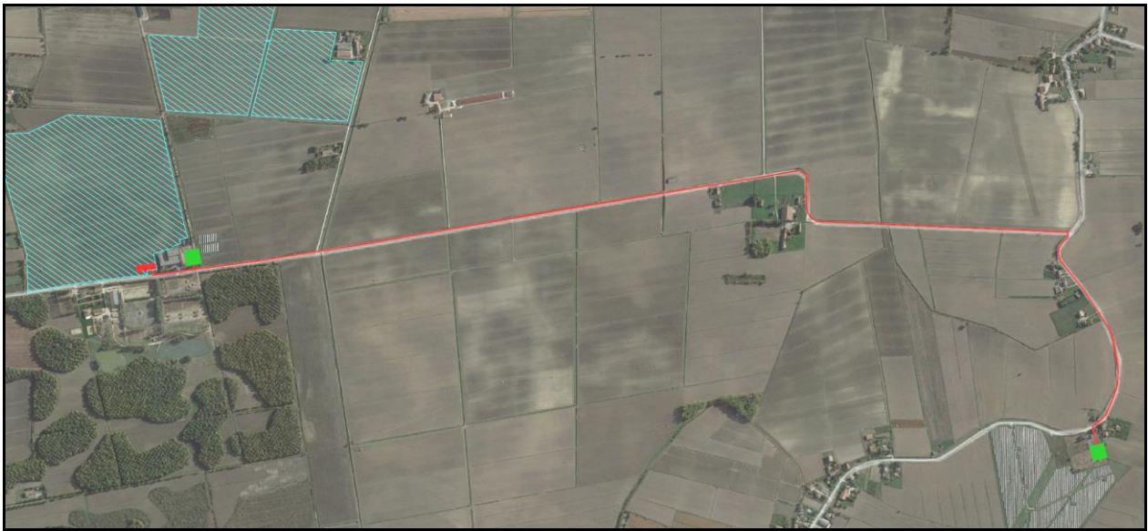
Figura 11: collegamento fra la cabina di consegna e la cabina elettrica esistente
