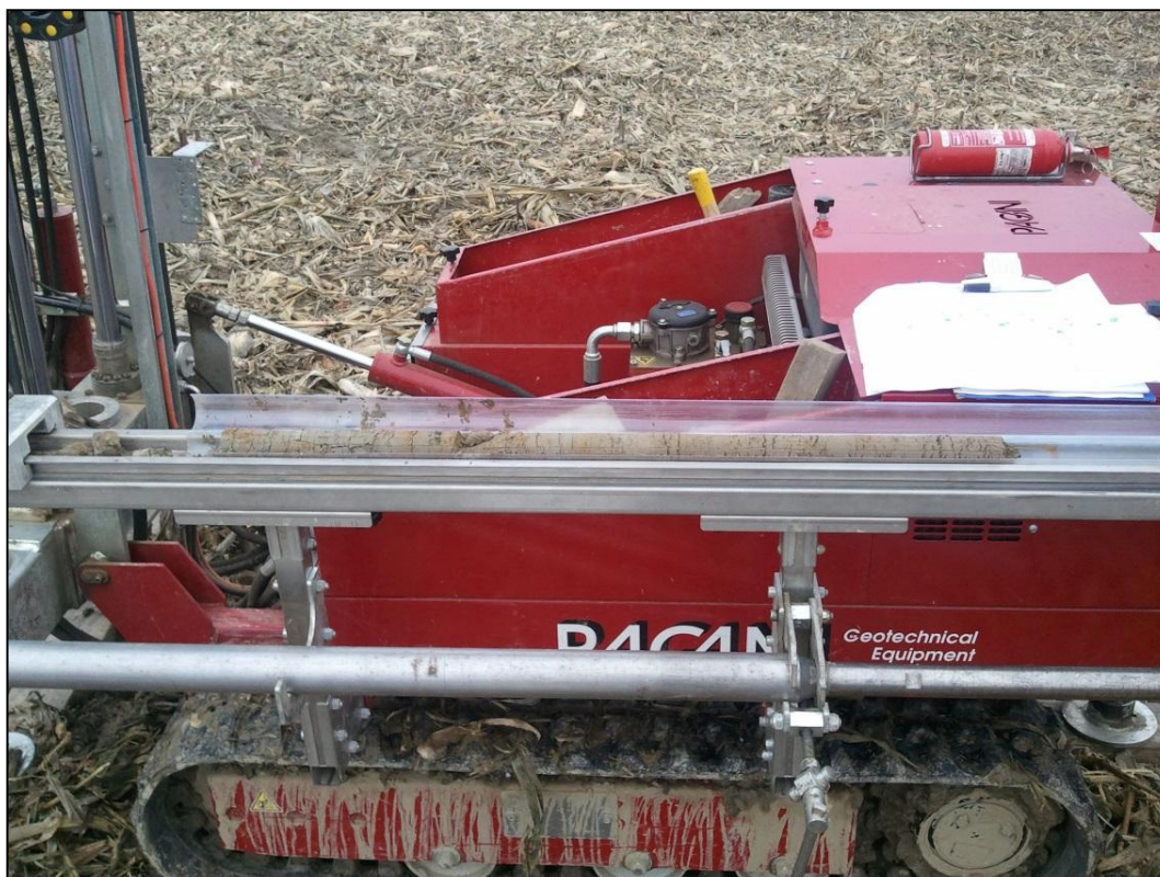
taglio fustella in pvc e prelievo terreno
