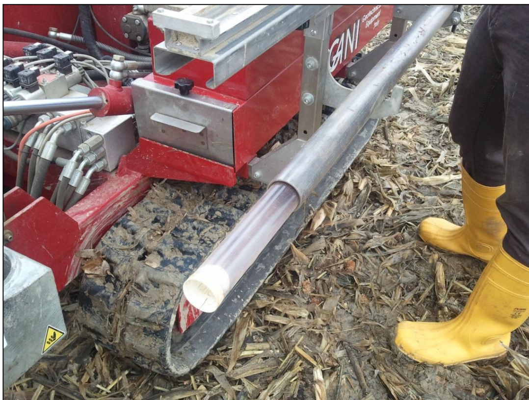
Esempio particolare fustella e campionatore
