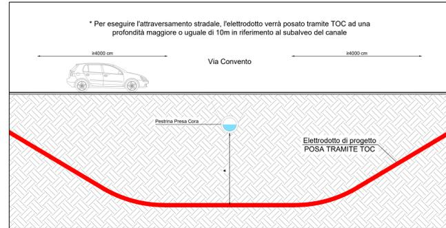
SEZIONE B-B - POSA ELETTRODOTTO - Scala 1:50
