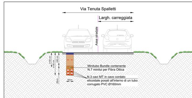
SEZIONE B-B - POSA ELETTRODOTTO - Scala 1:100
