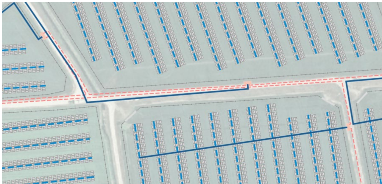
Percorso cavi solari BT di stringa su strutture di supporto dei tracker installati
