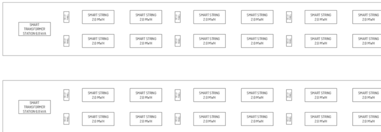
Schema a blocchi del sistema di accumulo BESS con componenti principali di impianto
