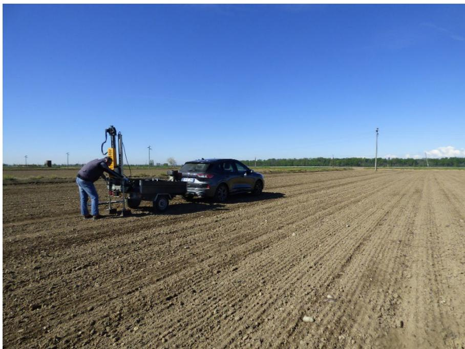
Prova penetrometrica DIN 2
