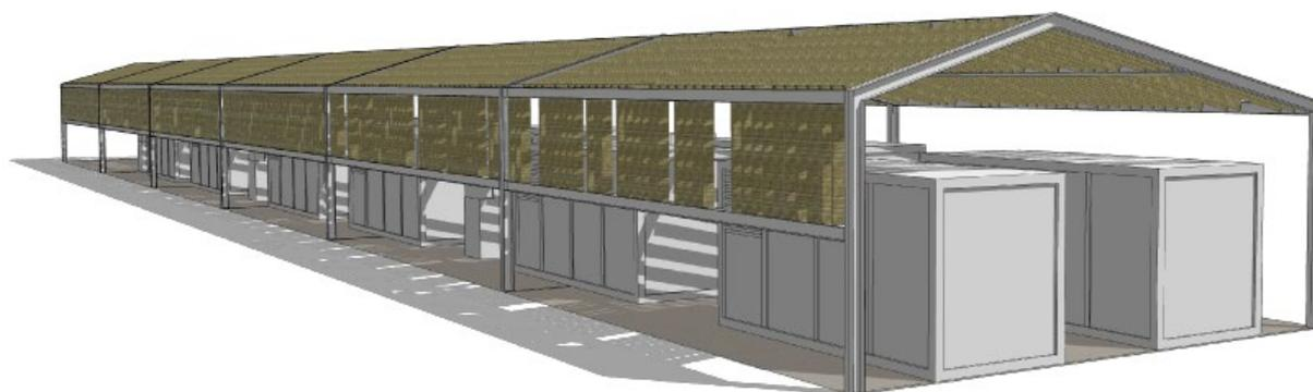
La copertura sarà fondamentalmente un ombracone permeabile articolato da una navata longitudinale dove le pareti e il tetto sono realizzate in listelli discontinui, generalmente in legno, collegati ai telai della struttura portante principale costituita da profilati metallici leggeri di tipo HEB.
