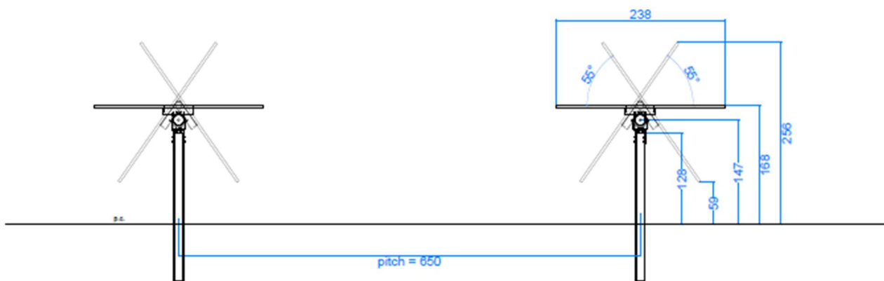
Figura 7. Sezione tipo dei Tracker fotovoltaici monoassiali a progetto. Vista con rotazione +/- 55°, pitch 6,5 metri.
