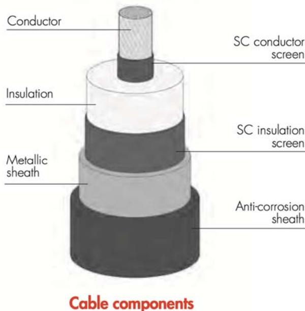
*Struttura di un cavo terrestre unipolare con isolamento in XLPE e armatura in acciaio*
