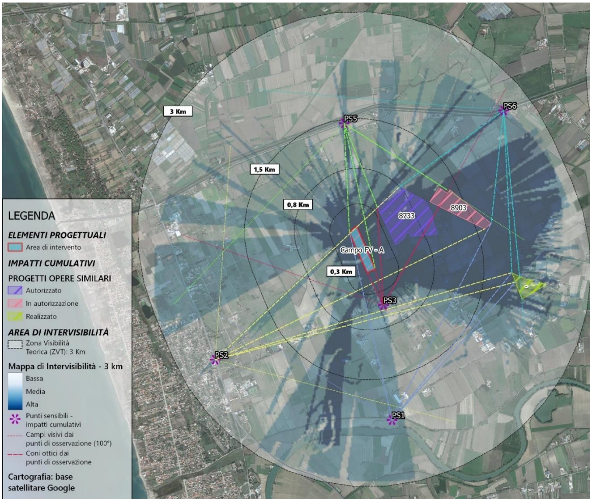
Immagine 14 - Campo FV A - Campi visivi e coni ottici dai punti sensibili. In evidenza con le linee tratteggiate i target di riferimento degli impianti cumulativi
