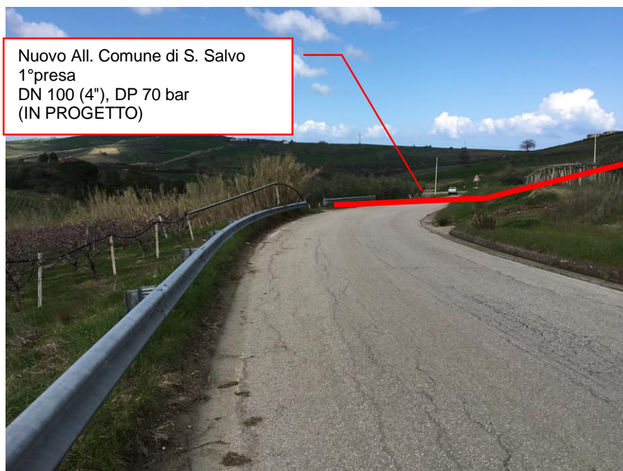
Foto n.34 – Km 0+145 - Metanodotto in progetto con attraversamento di S.P. n. 182 Via Maiella (CH)
