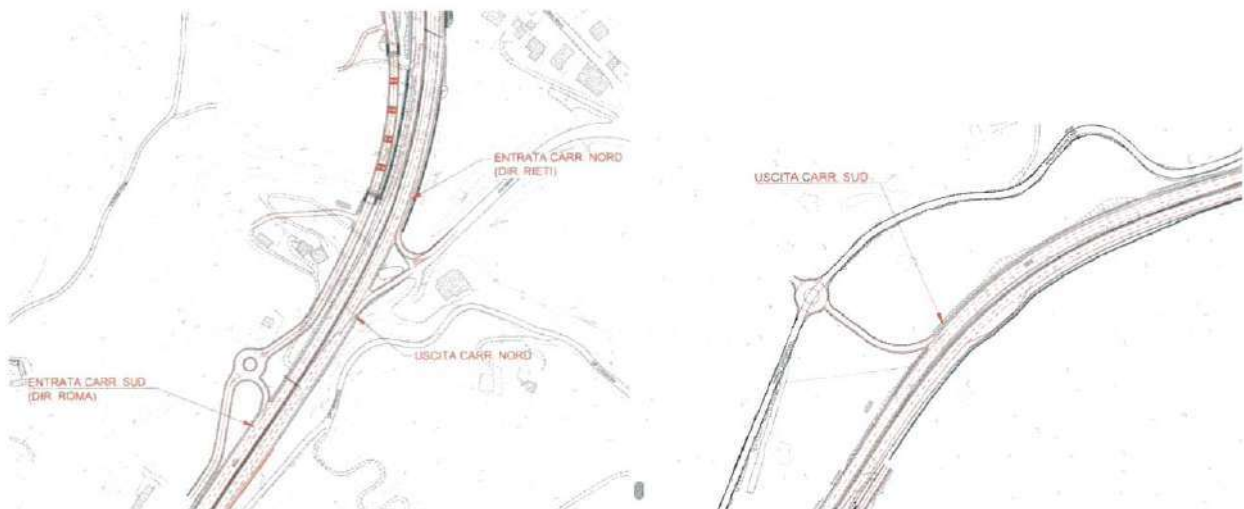
Fig. 21 Alternativa 3) Dettaglio delle rampe e rotatorie presentate in integrazione pp.50-51 del Riscontro. Per questo svincolo si prevede l’utilizzo del cavalcavia presente al km 64 della SS4 per il quale già nel progetto è contemplata demolizione e ricostruzione.
