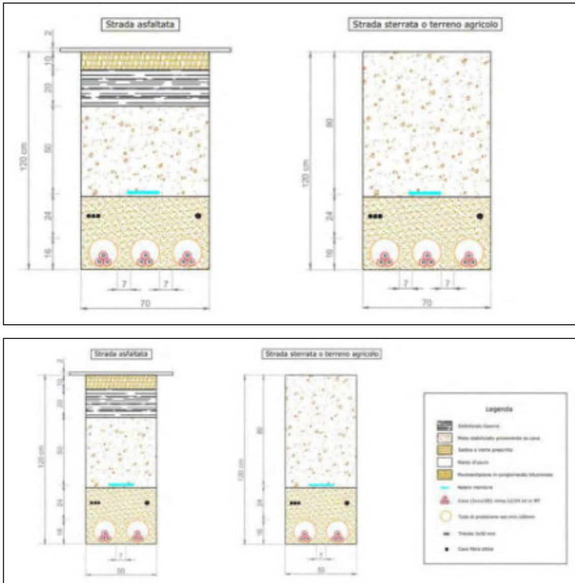
Figura 4 – Sezioni di scavo previste nel progetto
