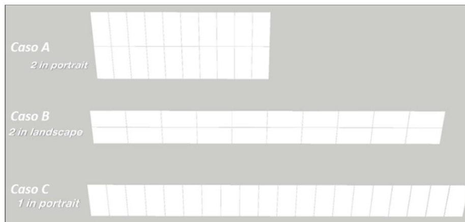
Fig. 1. Layout dell'inseguitore SOLTEC, con pannelli montati perpendicolarmente all'asse di rotazione.
