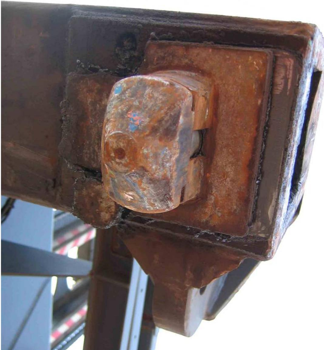
**Figura 59: particolare del sistema di aggancio dello spreader**
