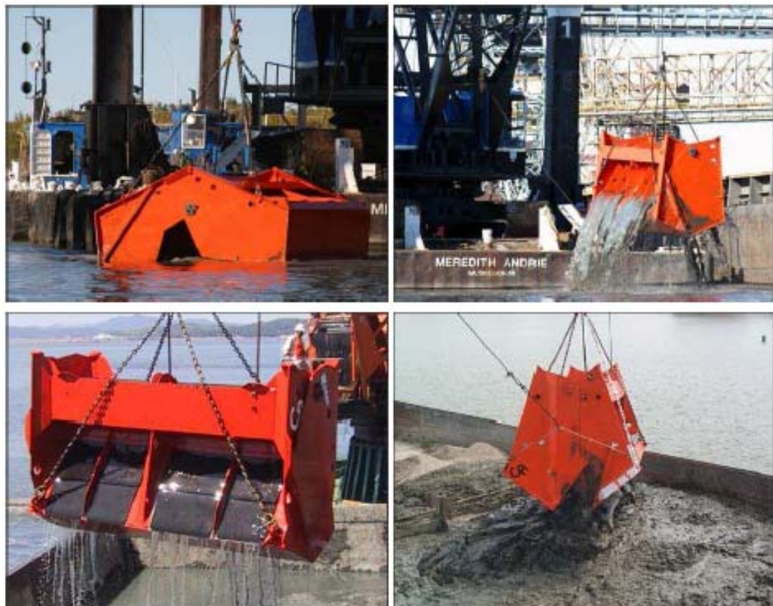
Figura 82-1 Benna ecologica: foto di cantiere.
