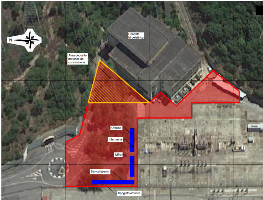
Figura 9: Pianta di Cantierizzazione
