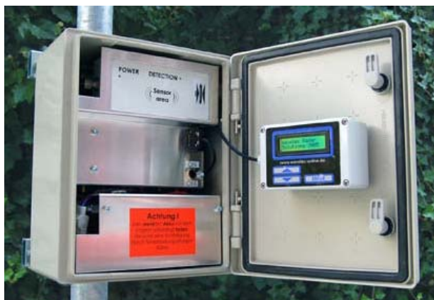
Radar ad effetto Doppler – tecnologia Wavetech
