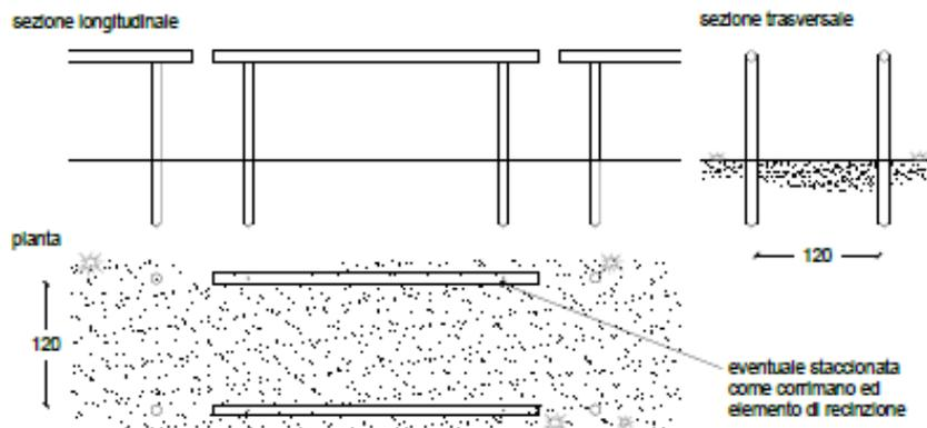
Figura 3-9 Esempio di sistemazione dei percorsi.
