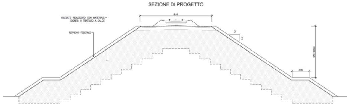
Figura 2-1 Intervento sui tratti in rilevato
