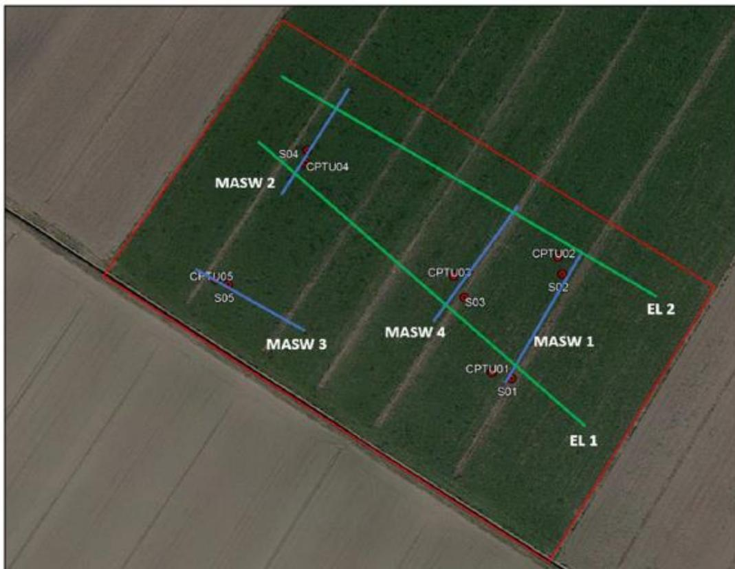
**Figura 10/B: Ubicazione dei sondaggi eseguiti nella campagna geologica 2021 nell'area delle Stazioni elettriche**
