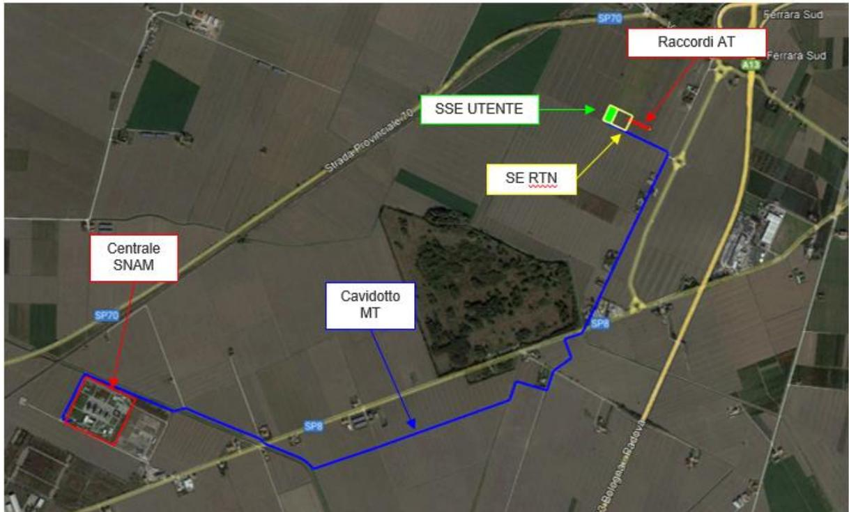
**Figura 1.3/B: Inquadramento territoriale della Centrale di compressione gas e delle opere di connessione (Google Earth). In blu il cavidotto interrato MT 15 kV di collegamento, in verde la SSE 132 kV /15 kV e in verde la SE RTN a 132 kV e iraccordi in rosso**
