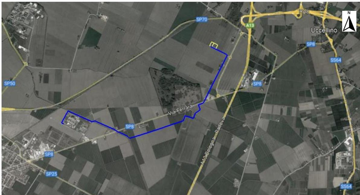
**Figura 1.2/A: Inquadramento territoriale della Centrale di compressione gas e delle opere di connessione (Google Earth). In blu il cavidotto interrato MT 15 kV di collegamento e in giallo le Stazioni SSE 132 kV /15 kV e la SE RTN a 132 kV**
