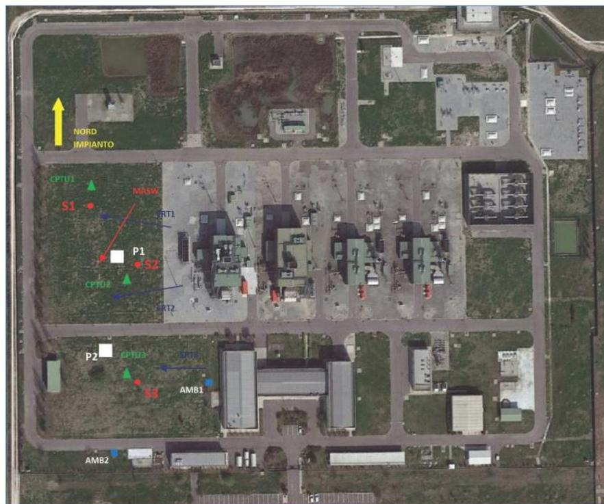
**Figura 10/A: Ubicazione dei sondaggi eseguiti nella Centrale di compressione**
