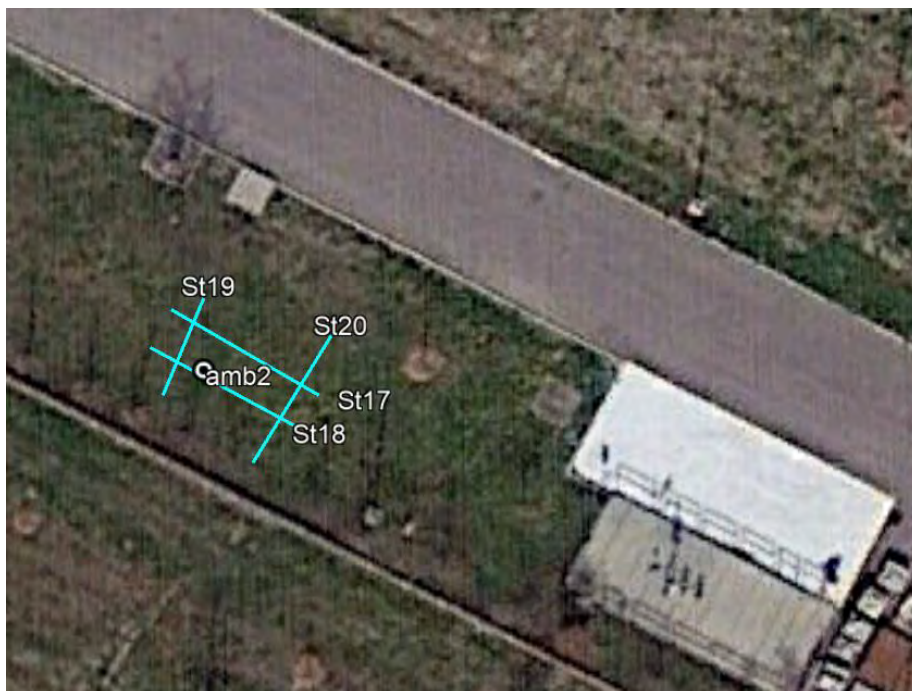
Figura 35: planimetria area di indagini tracce GPR da St17 a St20 (azzurre)
