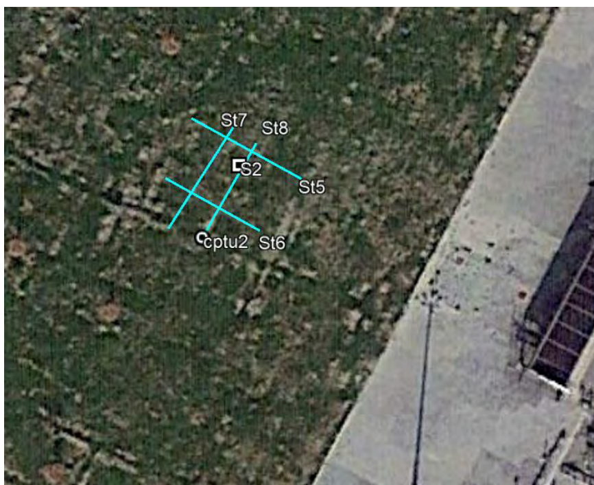
Figura 20: planimetria area di indagini tracce GPR da St5 a St8 (azzurre)
