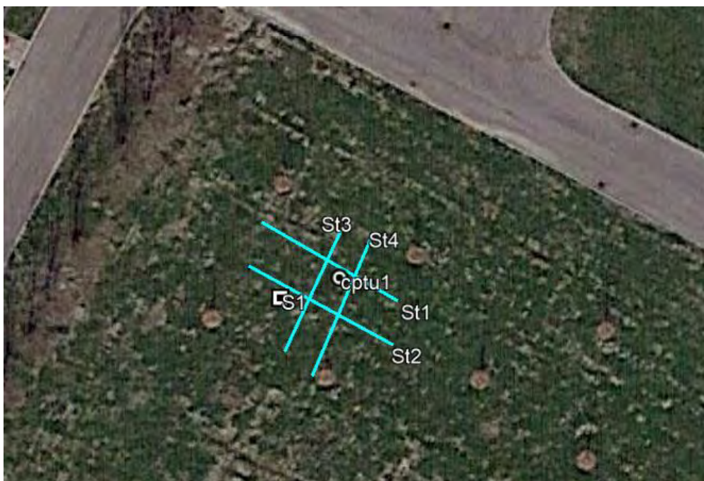
Figura 15: planimetria area di indagini tracce GPR da St1 a St4 (azzurre)
