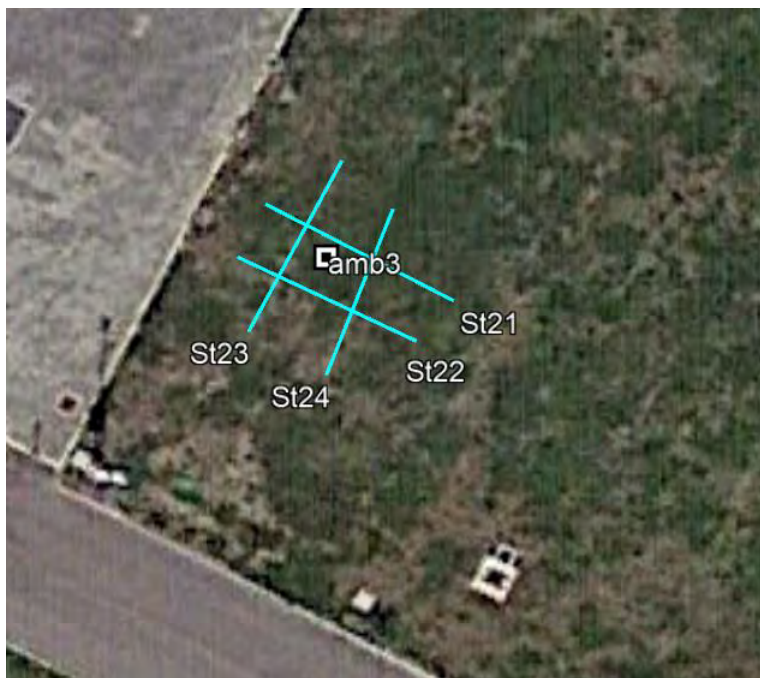
Figura 40: planimetria area di indagini tracce GPR da St21 a St24 (azzurre)
