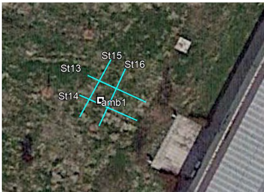
Figura 30: planimetria area di indagini tracce GPR da St13 a St16 (azzurre)
