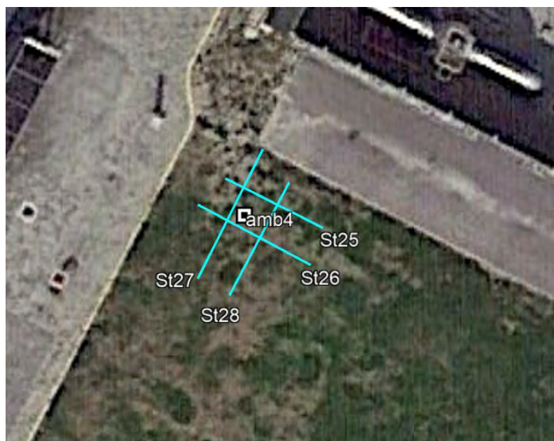
Figura 45: planimetria area di indagini tracce GPR da St25 a St28 (azzurre)
