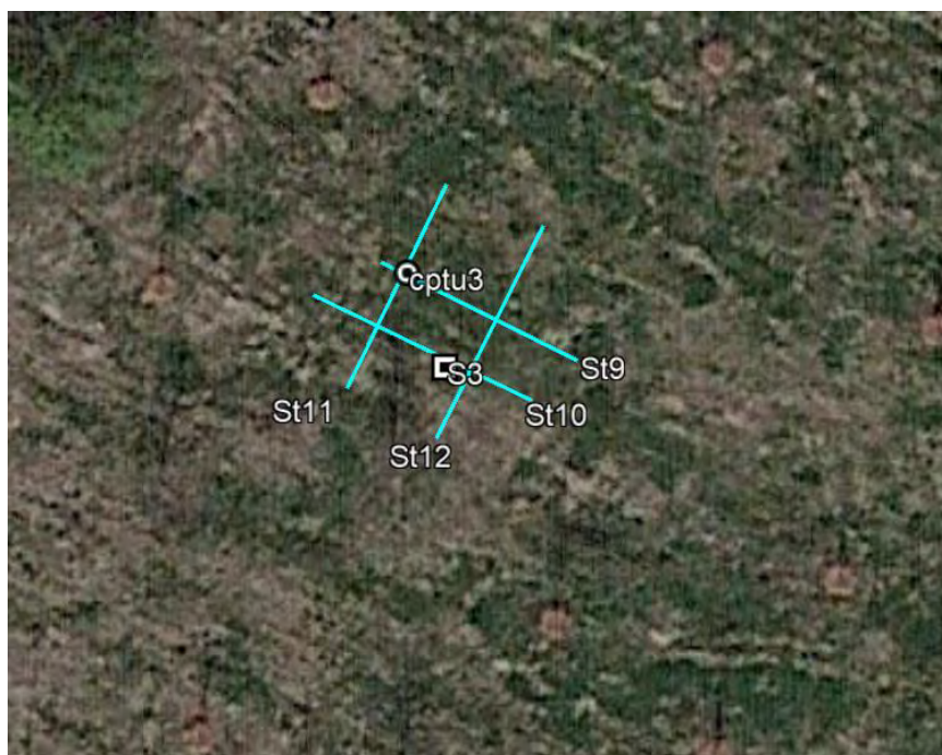
Figura 25: planimetria area di indagini tracce GPR da St9 a St12 (azzurre)
