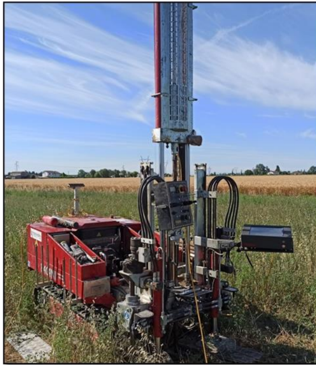
Figura 12 - Penetrometro statico Pagani
