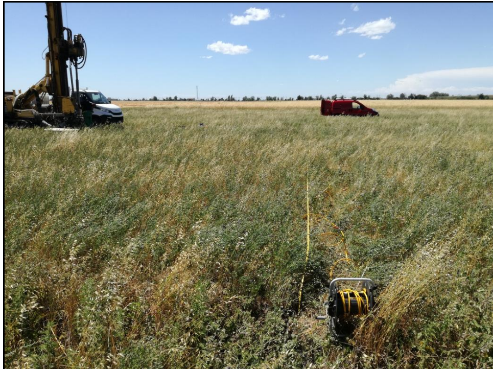
Figura 21 - Vista dello stendimento MASW M3.
