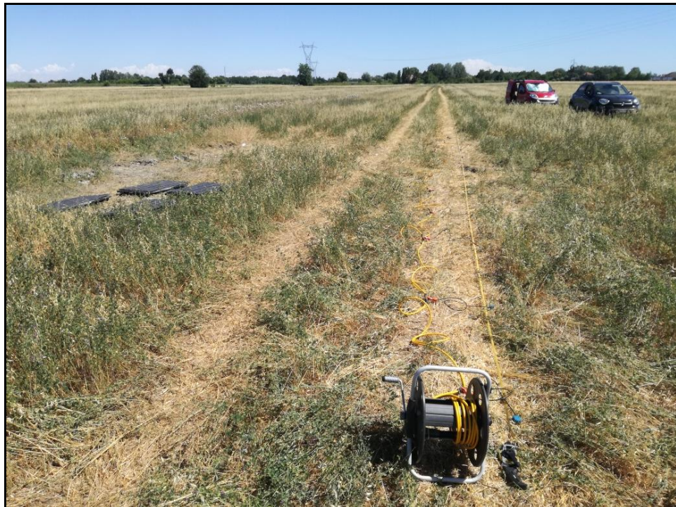
Figura 19 - Vista dello stendimento MASW M1.
