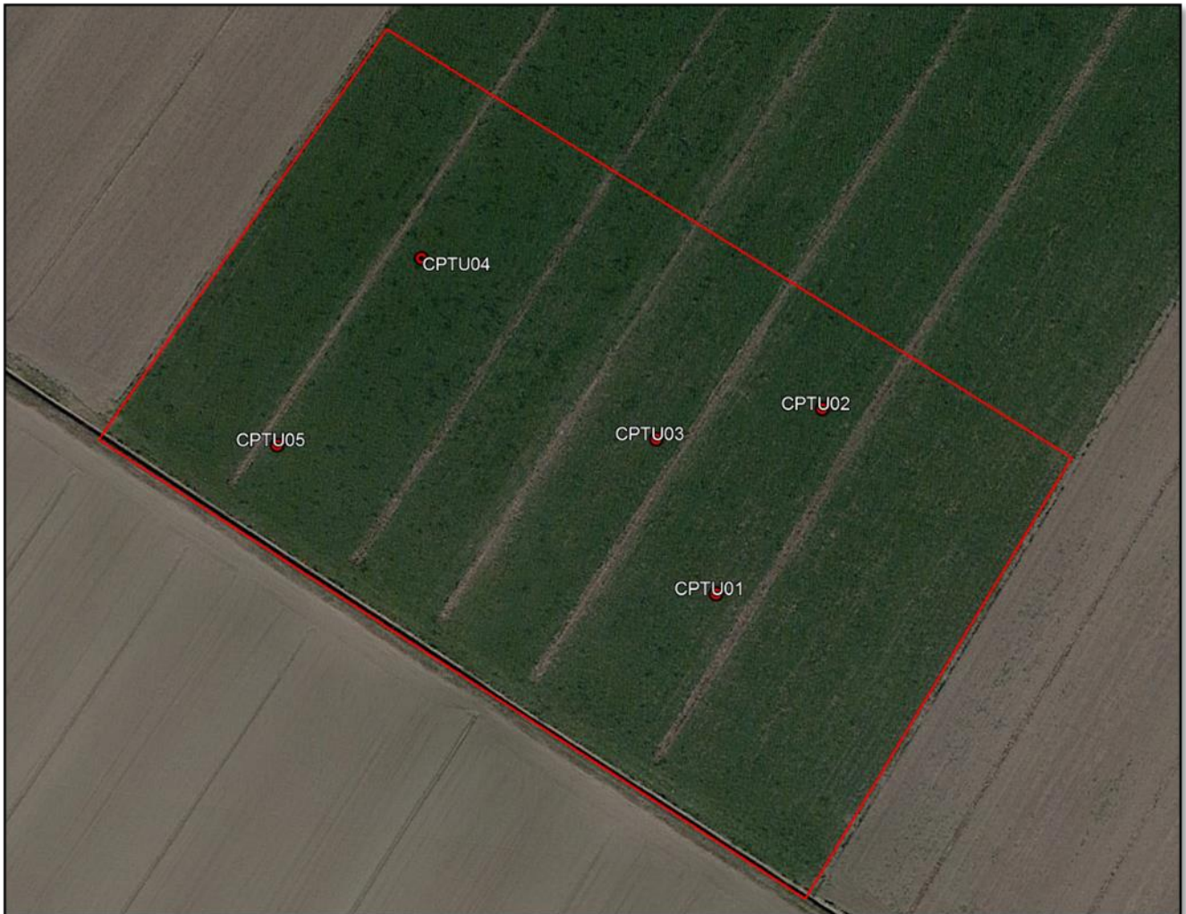
Figura 14 - Ubicazione delle prove penetrometriche statiche CPTU
