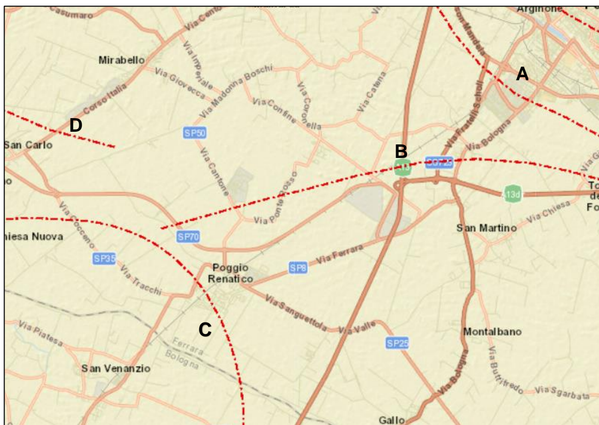
Figure 64: Le faglie capaci presenti in prossimità dell'area di studio, contenute nel database ITHACA (GeoMapView, ISPRA). A-Porotto Cassana – Ferrara; B-Ferrara; C-Poggio Renatico-Ferrara; D-Mirabello – Ferrara.
